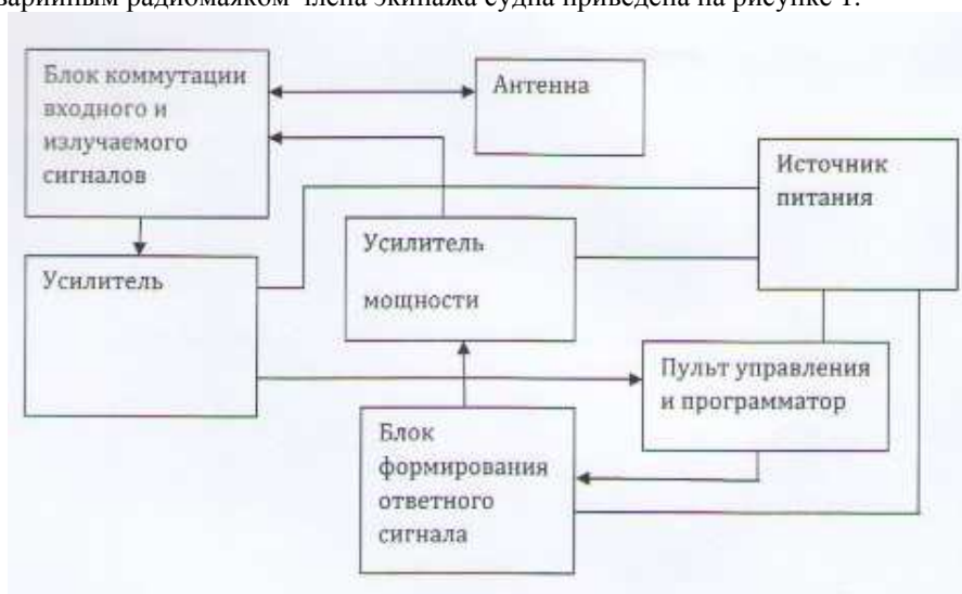
Рис. 1. Структурная схема радиоэлектронного устройства спасательного жилета
