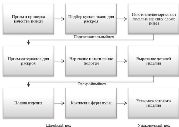
Рисунок 2 – Этапы производственного процесса швейного производства
