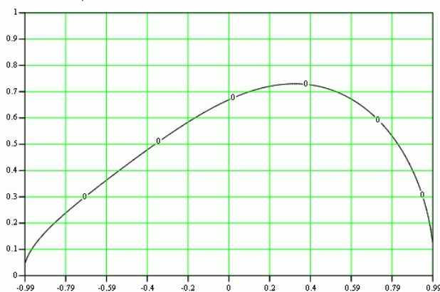
Рисунок 2 – Зависимость дальности полёта от угла вылета
