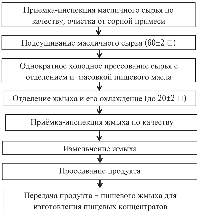
Рис. 1. Принципиальная технологическая схема получения жмыхов пищевого назначения
