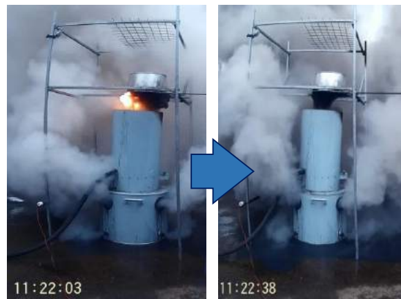
Рисунок 9. Работа УОА с параметрами воды: T=180 °С; P=2 МПа
