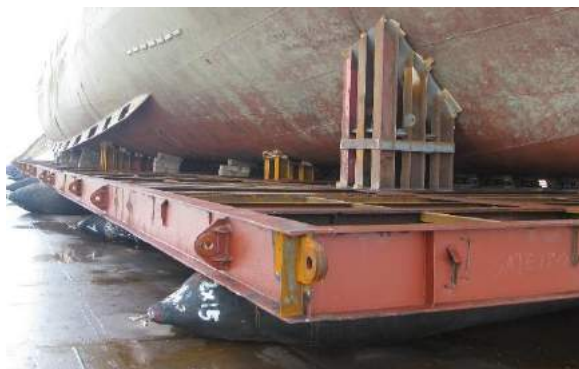
Рис. 1. Использование НЭО для перемещения судна с криволинейными обводами (судно установлено на оборудованную кильблоками платформу с плоской нижней поверхностью)
