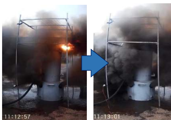
Рисунок 7 – Работа УОА с параметрами воды: T=20 °С; P=2 МПа
