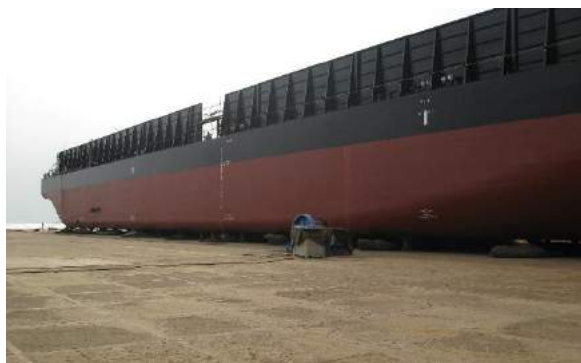
Рис. 2. Подготовка плоскодонного судна к перемещению в плавучий док для спуска на воду (НЭО укладывают непосредственно под днище)
