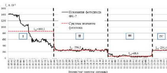
Рисунок 8 – График изменение фототока в процессе работы УОА (с параметрами воды P=2 МПа; T=180 °С) и осаждения продуктов горения от дымовой шашки РДГ-24
