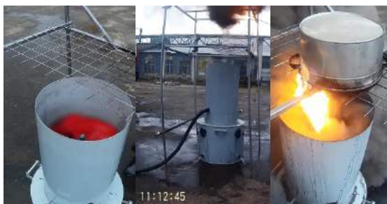
Рисунок 5 – Работа УОА с параметрами подаваемой воды: P=2 МПа; T=20 °С
