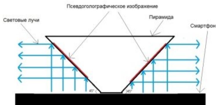
Рис. 2. Ход лучей в голографической пирамиде
