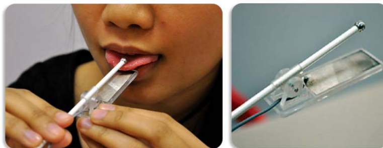
Рис. 1. Электрод, способный имитировать вкусовые ощущения
