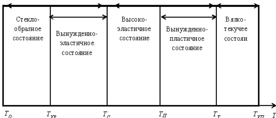
Схема промежуточных состояний битумов и пеков при переходе из твердого в жидкое состояние
