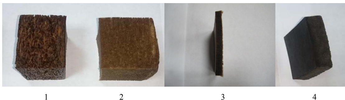
Образцы плит после испытания на водостойкость методом кипячения: 1 – ДСтП; 2 – МДФ; 3 – ДВП; 4 – Плита без связующего
