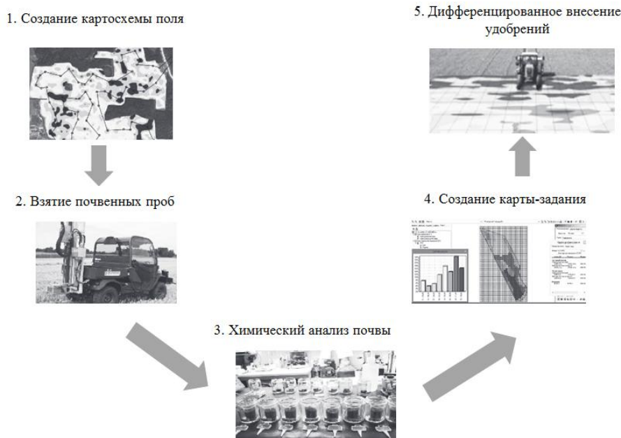
Рисунок 6 – Основные этапы дифференцированного внесения удобрений
