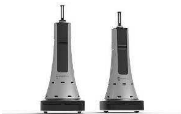
Рис. 3. Робота-мерчандайзер с RFID-считывателями
