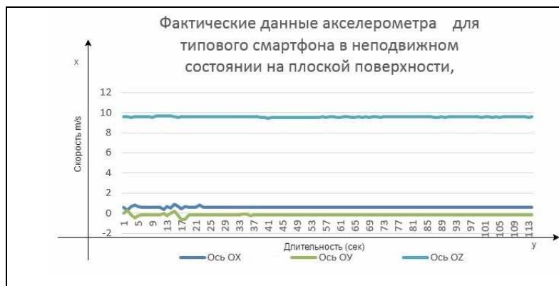
Рис. 1. Данные акселерометра смартфона в неподвижном состоянии
