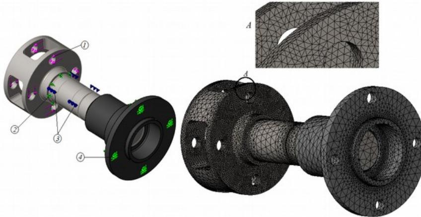
Рисунок 2. Конечно-элементная модель водила тихоходного планетарного ряда мотор-редуктора
