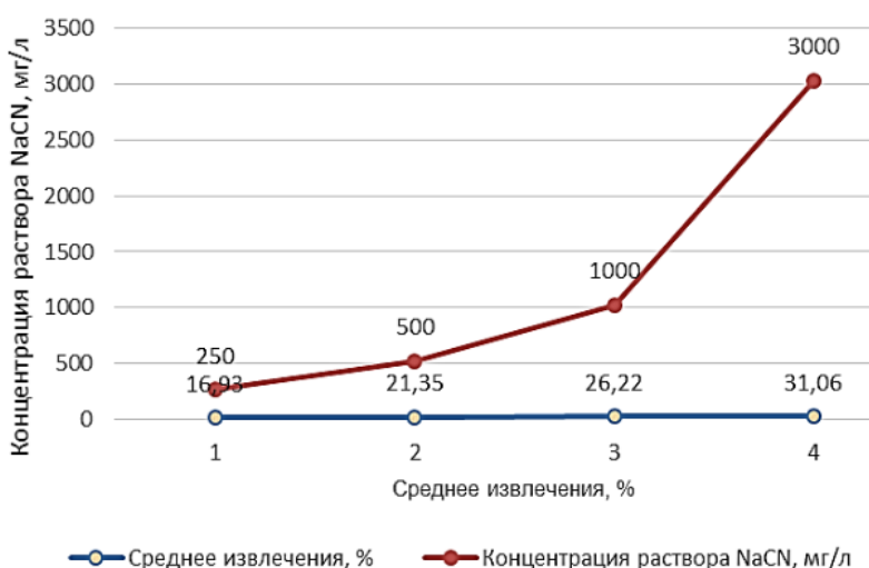
Рисунок 1. Зависимость извлечения золота от концентрации NaCN измельченной до -0,074 мм 65 % пробы хвостов
